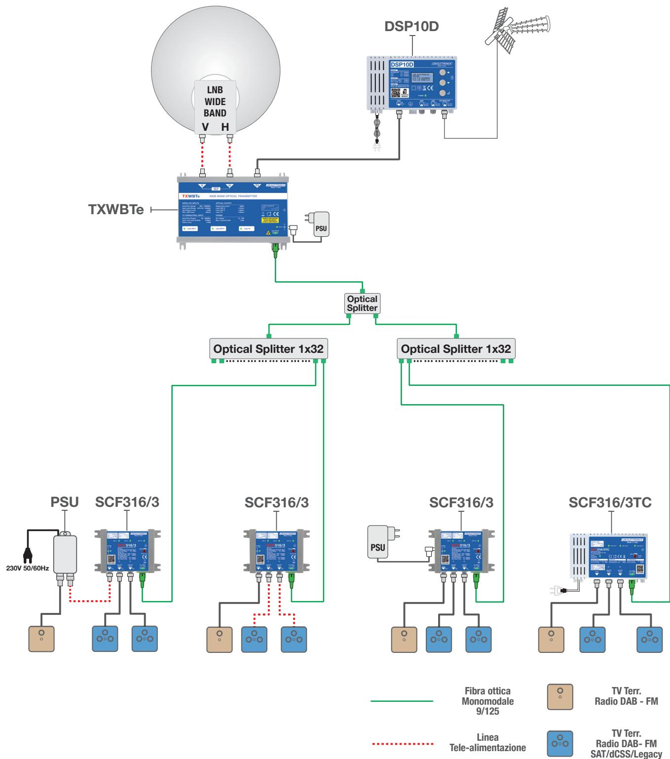
**Distribuzione dei segnali di un singolo satellite e della TV terrestre tramite una singola fibra ottica monomodale con multiswitch ottici serie SCF316.**
