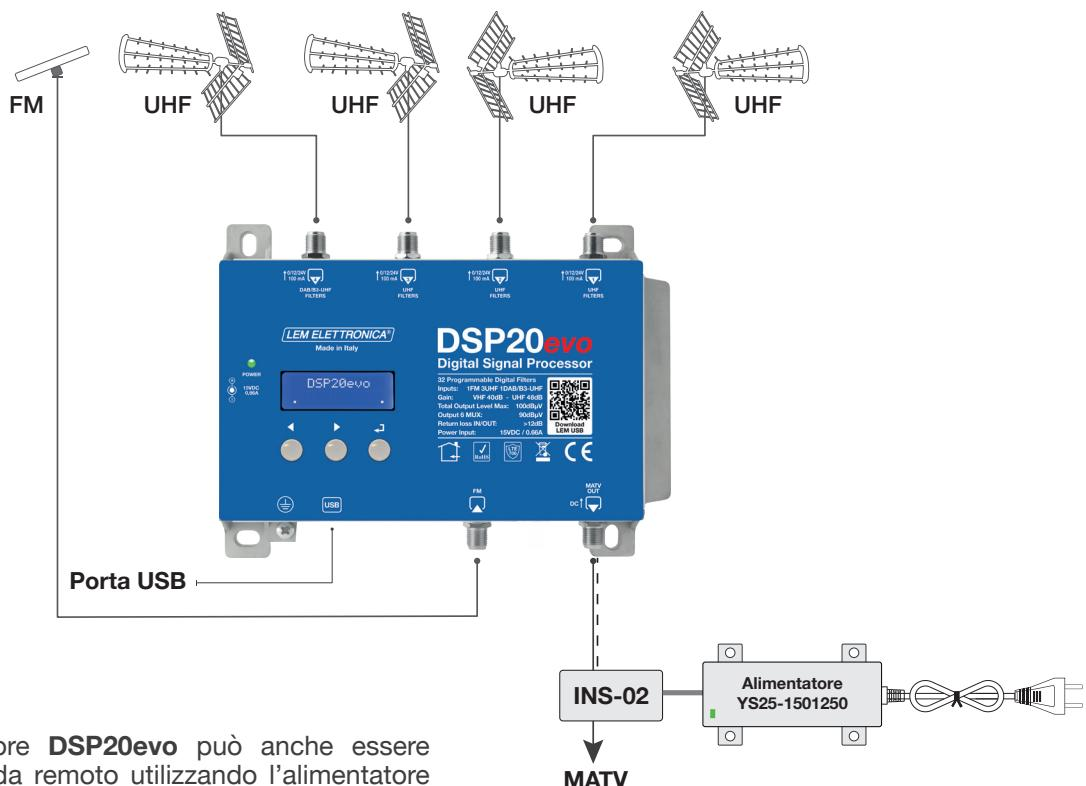
L'amplificatore **DSP20evo** può anche essere alimentato da remoto utilizzando l'alimentatore fornito a corredo unitamente a un inseritore di tensione per cavo coassiale **INS-02\***.
