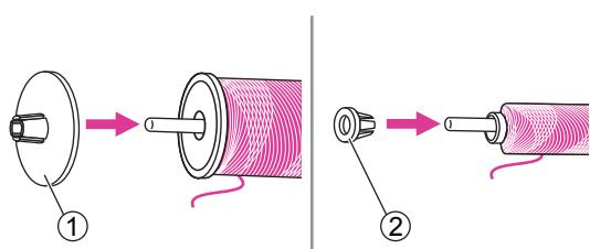
1. Posizionare il rochetto di filo ed il fermo spola all'interno del porta spola orizzontale. Scegliere il fermo spola (grande o piccolo) in base al diametro del rochetto di filo spingendo-lo contro il rochetto fino a farlo aderire ad esso.
