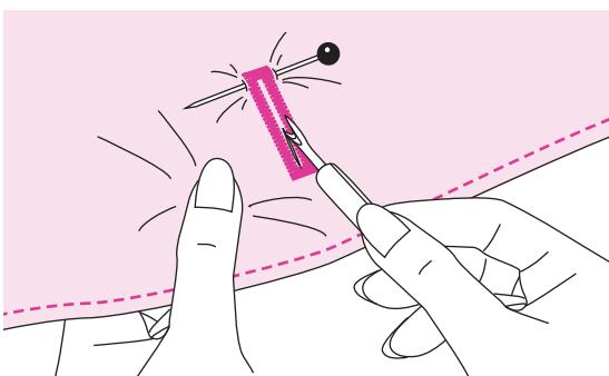
Utilizzando l'apri asola, tagliare l'asola tra le due travette senza oltrepassare i punti cuciti (servirsi di uno spillino come dispositivo di arresto da posizionare all'estremità della travetta).
