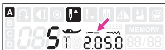
La lunghezza punto può essere regolata premendo il relativo tasto " + " per allungare oppure " - " per accorciare. Il punto zigzag standard è impostato su "2.5" o inferiore.
