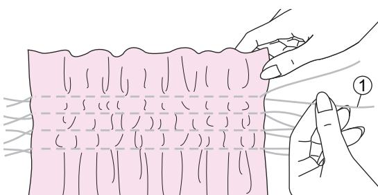
Afferrare i fili superiore ed inferiore e tirare delicatamente distribuendo l'arricciatura lungo le file di cuciture a punto dritto (imbastitura). Terminata l'operazione, annodare i fili per fermare l'arricciatura in posizione.
