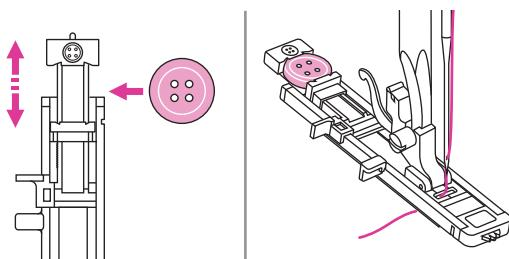
Facendo aderire il supporto bottone allo stesso, la dimensione dell'asola viene automaticamente determinata.
