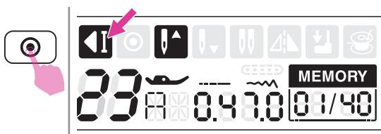
Premendo il tasto nodo automatico, al termine della cucitura la macchina eseguirà 3 punti sulla stessa battuta d'ago alla fine della combinazione dell'ultima unità in sequenza ferman-dosi automaticamente. Il display LCD mostra l'icona auto-stop. Premendo il tasto start/stop viene ripetuta la cucitura della sequenza.
