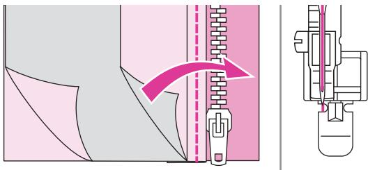
Girare il tessuto al dritto e cucire lungo l'estremità inferiore e il lato destro della cerniera.
