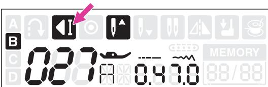
Quando la macchina sta cucendo: impostando i punti a selezione diretta del gruppo A da 1 a 5 oppure il punto 000 del gruppo B premendo il tasto nodo automatico la macchina esegue 3 punti sulla stessa battuta d'ago per poi fermarsi automaticamente.
