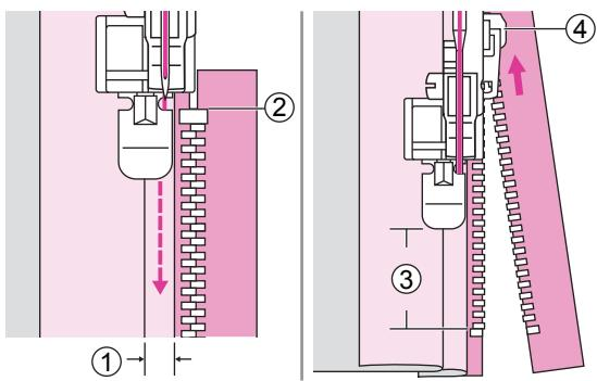
Inserire il piedino cerniera lampo sull'attacco del perno destro.
