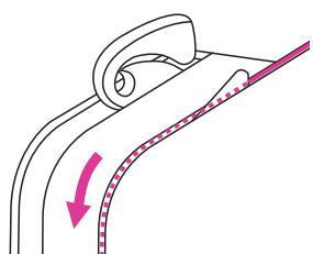
6. Continuare guidando il filo in basso lungo la fessura di destra dei dischi tensione.
