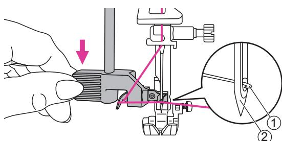
12. L'uncino girando si posiziona davanti la cruna dell'ago e subito dopo si inserisce al suo interno per predisporne l'infilatura automatica.
