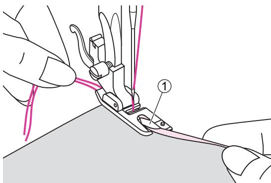
Abbassare il piedino in corrispondenza dell'inizio del bordo; girare il volantino verso sè ed eseguire manualmente alcuni punti dritti. Sollevare il piedino e tagliare i fili lasciando un lungo scarto dietro.
