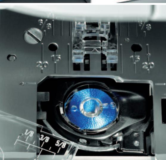
Crochet rotativo con coperchio trasparente per controllare costantemente quanto filo avete a disposizione
