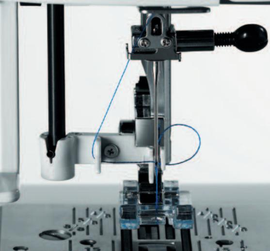
L'infilata ago automatico è pratico e veloce: vi aiuta ad ottimizzare il tempo ed accelerare l'operazione di infilatura superiore del filo
