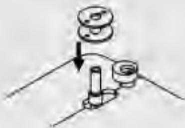
4. Spingete il filarello a destra, tenendo l'estremità del filo. Premete lentamente il reostato per iniziare l'avvolgimento.
