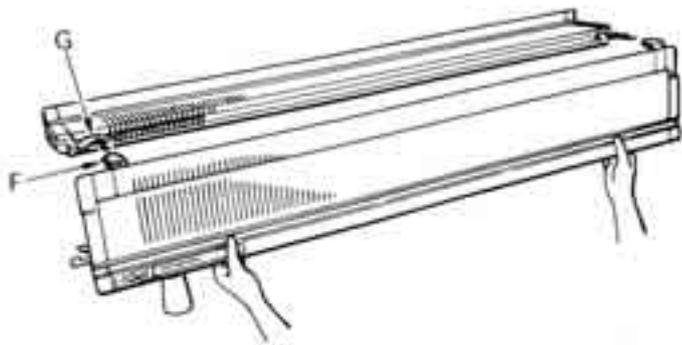
4. Tenendo la seconda frontura con entrambe le mani inserire gli attacchi «F» situati su entrambi i lati della seconda frontura, nelle apposite fessure «G» situate ai due lati della prima frontura. Inserire prima il lato destro quindi il sinistro.
