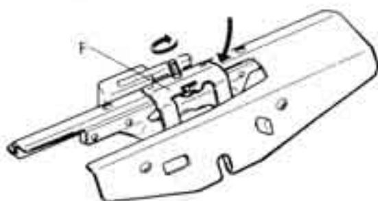
Usare il guidafile del vanisé «F» solo per il vanisé in seconda frontura
